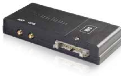
Приёмопередающая установка Иридиум 9522В по передаче голосовых и цифровых данных
